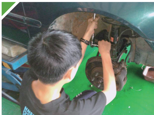
避震器拆解訓練
