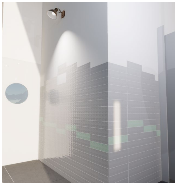
磚面凹凸、磚面及水泥漆面不同反射率，提供使用者在空間動作時，看到不同光影反射效果。
