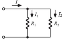
1. 若  $I_1$  電流為 2A， $I_2$  電流為 5A，試求電流  $I$  為多少安培?
